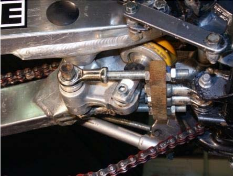
PARTICOLARE DELLA SOSPENSIONE POSTERIORE SI VEDONO GLI UNIBALL E I DADI PER I REGISTRI CHE CONSENTONO DI ALZARE O ABBASSARE LA MOTO
